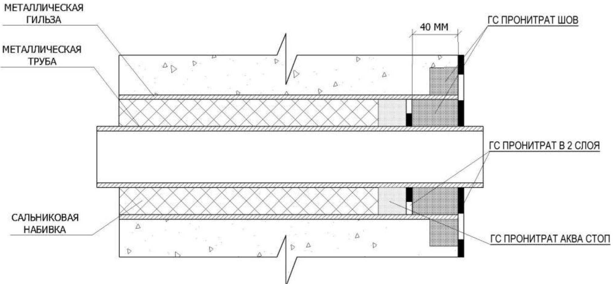
Рисунок Б.3 – Устройство гидроизоляции мест ввода коммуникаций
