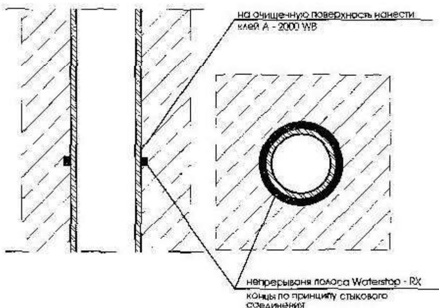
Рисунок В.8 – Проход кабеля в стальнойной защитной втулке
