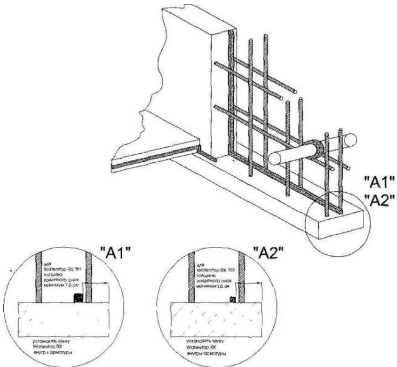
Рисунок В.9 – Изоляция прохода с втулкой для элемента инженерной системы через отверстие, шире толщины бетонитового шнуря.
