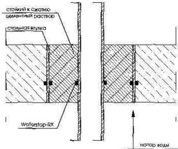
Рисунок В.7 – Уплотнение перехода группы кабелей через отверстие в конструкции с использованием бетонитового шнуря
