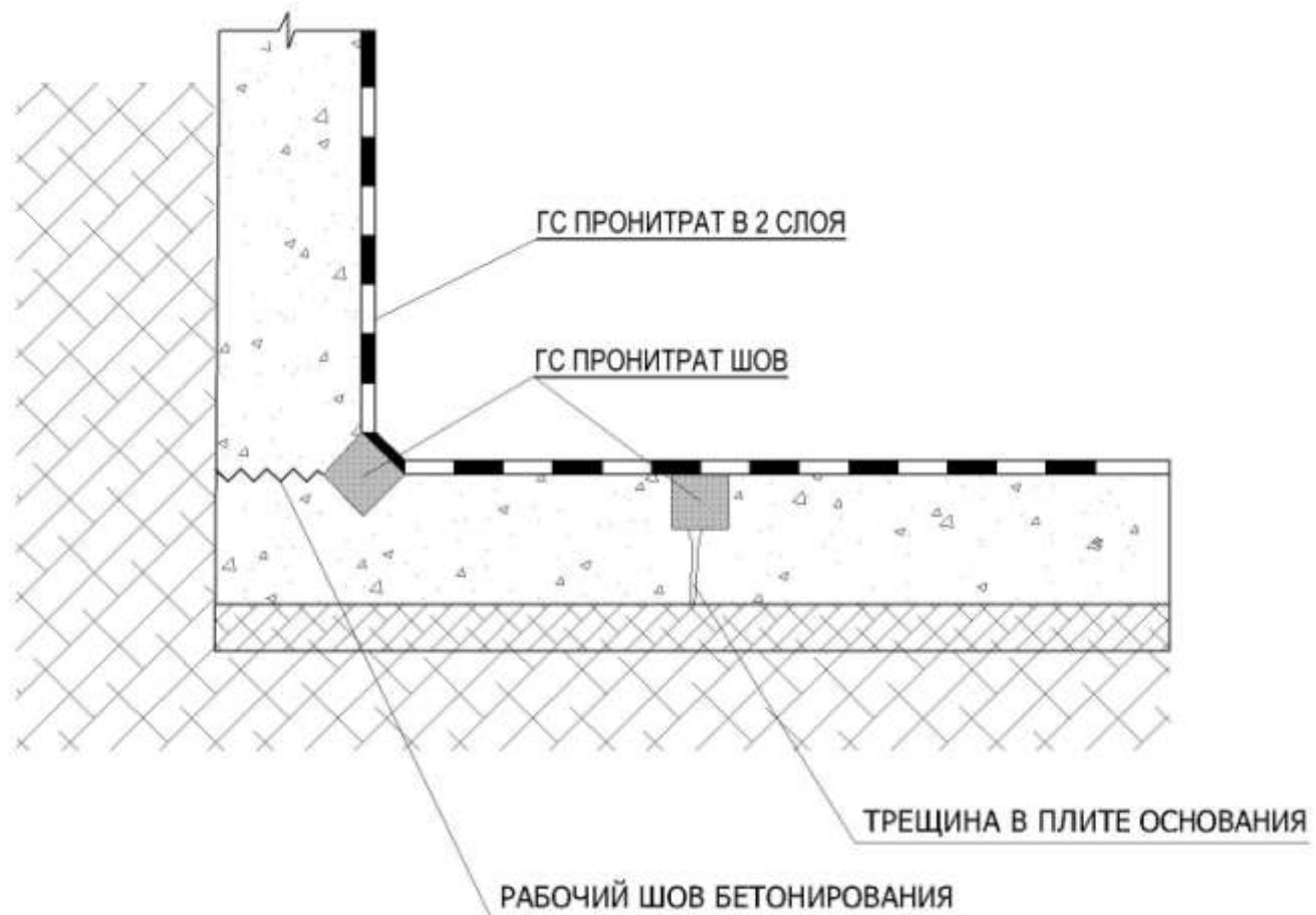
Рисунок Б.6 – Устройство гидроизоляции монолитного бетонного пола
