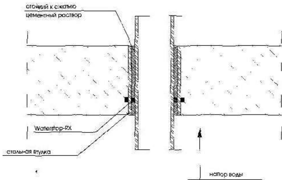
Рисунок В.2 – Типичные места установки бетонитового шнура
