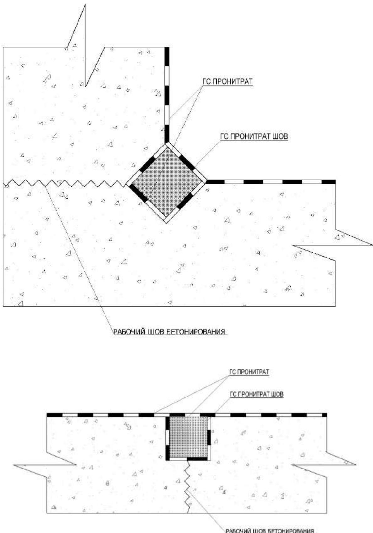
Рисунок Б.1 – Устройство гидроизоляции рабочих швов бетонирования
