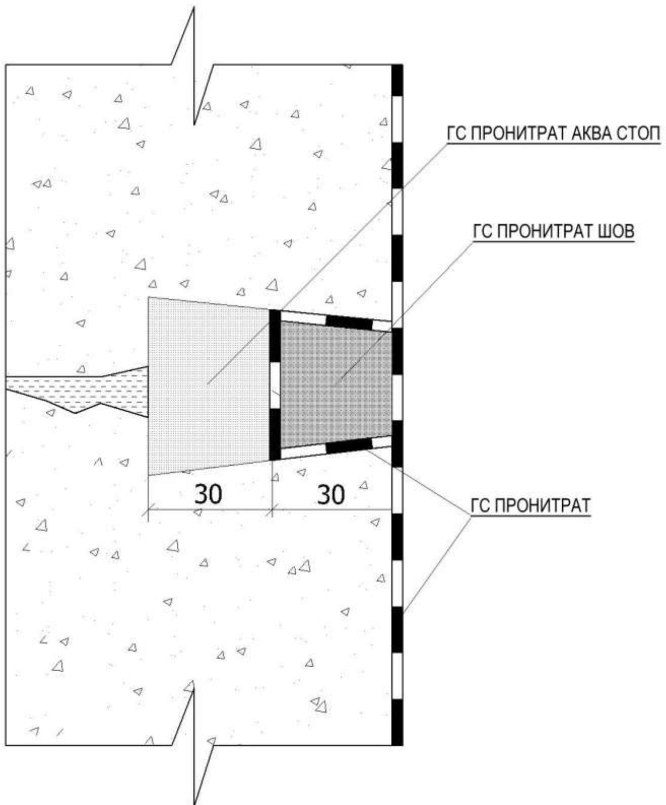
Рисунок Б.2 – Схема ликвидации напорной течи
