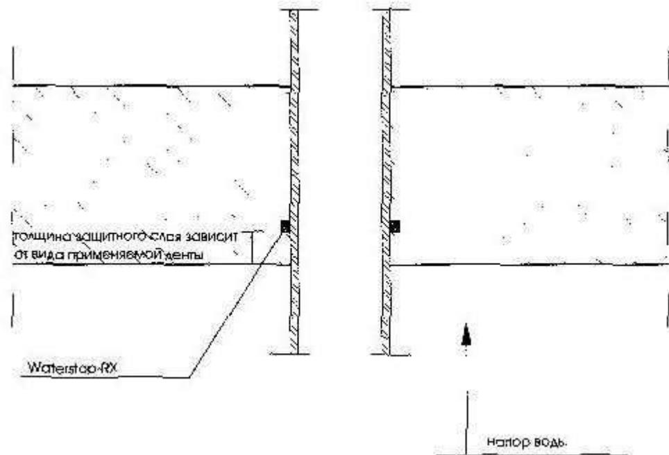
Рисунок В.1 – Уплотнительный эффект бетонитового шнура
