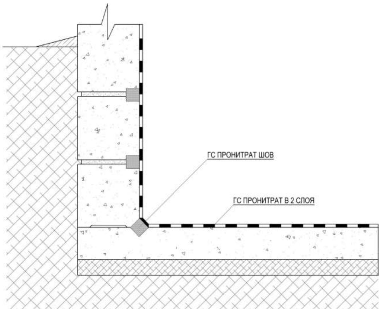
Рисунок Б.8 – Устройство гидроизоляции стены,
