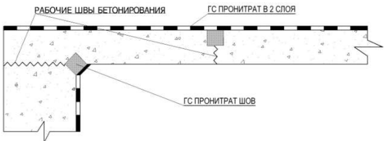
Рисунок Б.5 – Устройство гидроизоляции монолитных перекрытий
