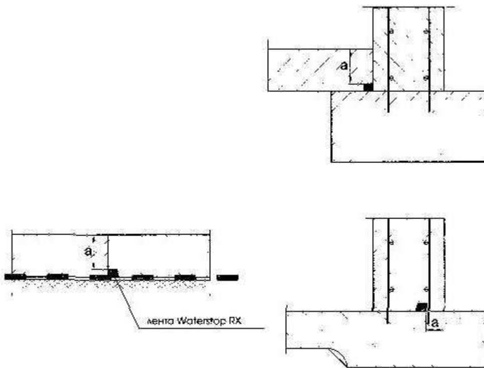
Рисунок В.3 – Типичные применения шнуро́в (лент) в соединениях же́лезобетонных эле-
